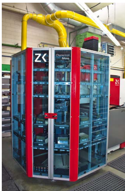
Dreimal mehr Elektrodenplätze: Das Chameleon Mono bietet Platz für 12 Werkstückpaletten und 72 Elektrodenhalter.
