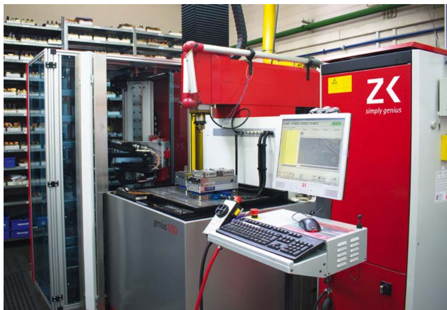
Umgerüstet: Die vorhandene Senkerodiermaschine genius 850 von ZK wurde nachträglich um ein Handlingsystem für Werkstücke und Elektroden erweitert. (© Zimmer & Kreim)
