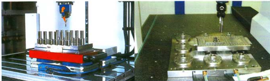
Bild 1: 2 x Power-Grip 2-fach, mit 2 x 2er Paletten - Senkerosion -
