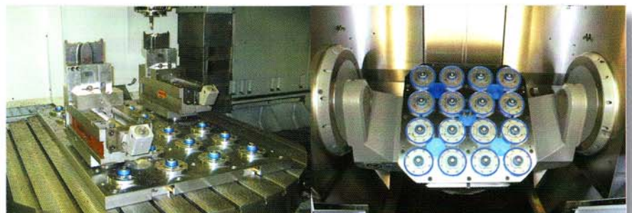
Bild 3: Power-Grip 24-fach, mit 2 x 2er Paletten - Fräsen - (Werkbilder: Partool GmbH & Co. KG, Nürnberg)
