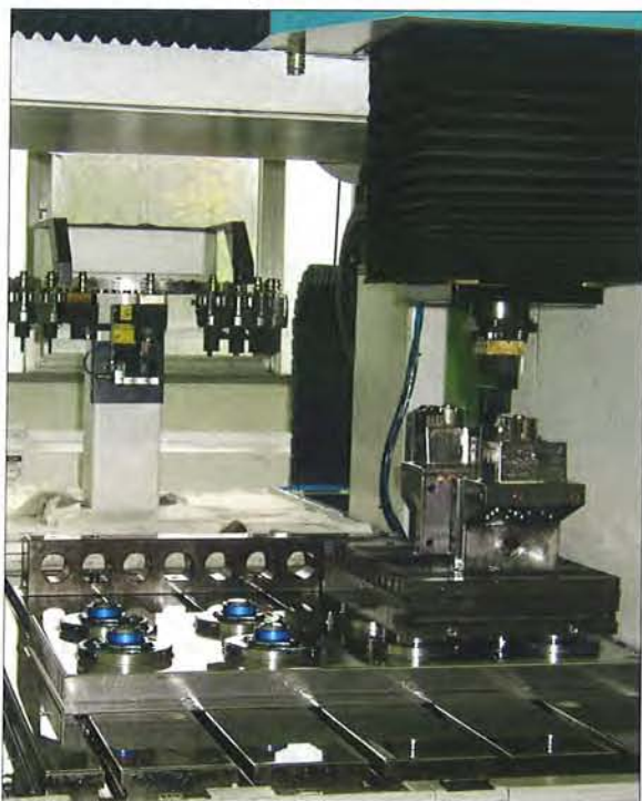
Der modulare Aufbau von Power-Grip bietet höchste Flexibilität. Mit nur einer Schnittstelle kann bereichsübergreifend vom Messen, Fräsen, Draht- und Senkerodieren bis hin zum Schleifen, Bohren und Lasern gearbeitet werden.
