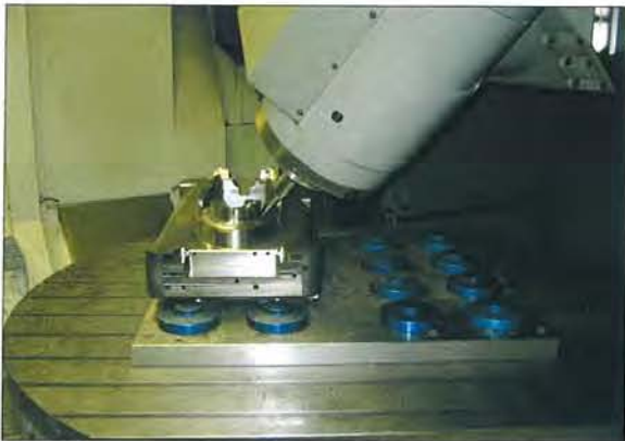
Der modulare Aufbau von Power-Grip bietet höchste Flexibilität. Mit nur einer Schnittstelle kann bereichsübergreifend vom Messen, Fräsen, Draht- und Senkerodieren bis hin zum Schleifen, Bohren und Lasern gearbeitet werden.
