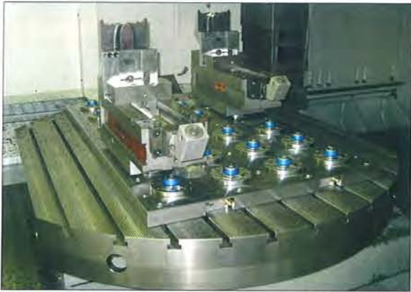
Die Palettisierung mit dem Power-Grip-System von Partool ist wesentlicher Bestandteil der Automation im Stahlfräsen. In Verbindung mit der Chip-Identifikation und dem automatischen Job-Laden wird ein reibungsfreier Schichtbetrieb ermöglicht.
